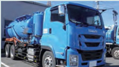
10t 大型強力吸引車 風量40m³/min
