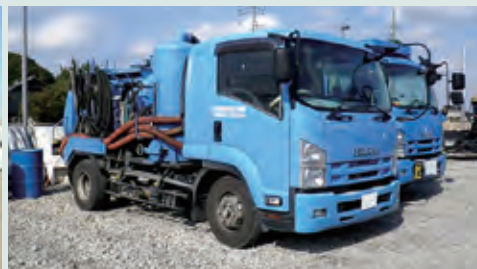
4t 中型強力吸引車 風量40m³/min
