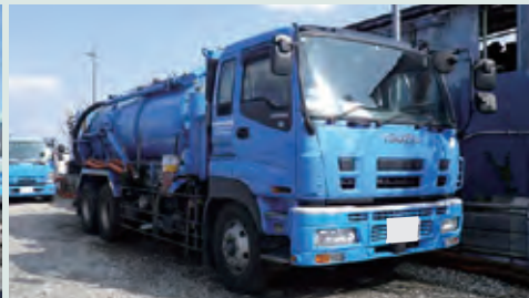
10t 大型強力吸引車 風量20m³/min
