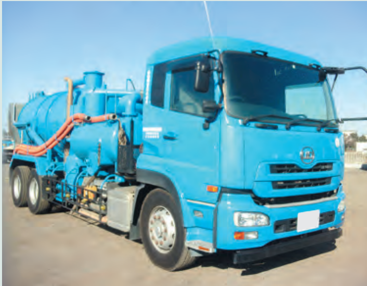
産廃回収車両 10t 大型強力吸引車 風量70m³/min
