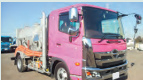
4t 中型強力吸引車 風量40m³/min
