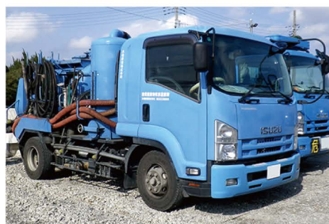
4t 中型強力吸引車 風量40m³/min
