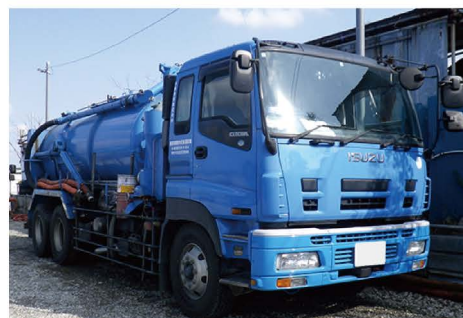
10t 大型強力吸引車 風量40m³/min
